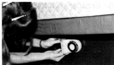
11. Fixez le régulateur au socle ou au bois de lit avec du ruban adhésif double face ou avec les vis.
